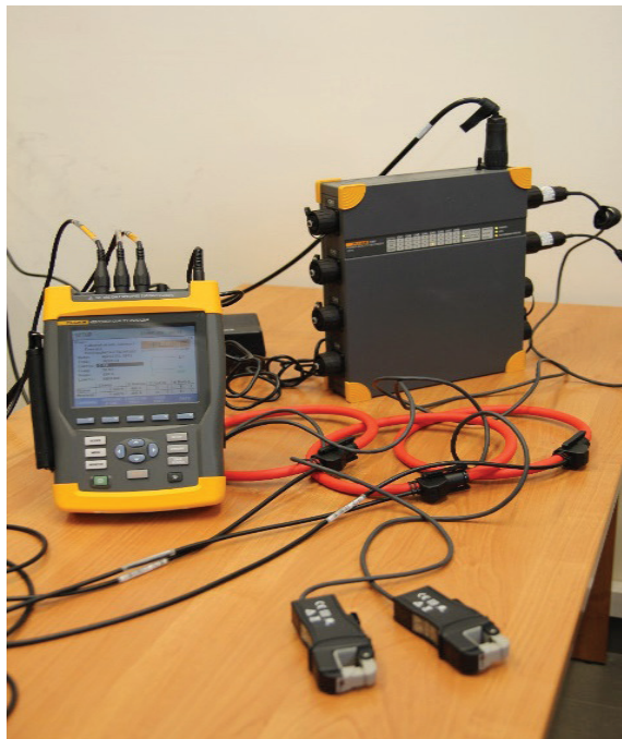
Trójfazowy analizator jakości energii elektrycznej Fluke 1760
