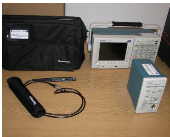
Oscyloskop cyfrowy Tektronix TDS3034C
