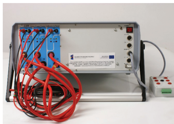
Trójfazowy kalibrator mocy i tester aparatury energetycznej typu C300
