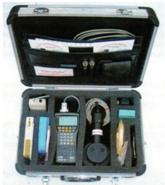
Zestaw pomiarowy GalvaPulse™ GP-5000 do oceny zagrożenia korozją stali zbrojeniowej w betonie
