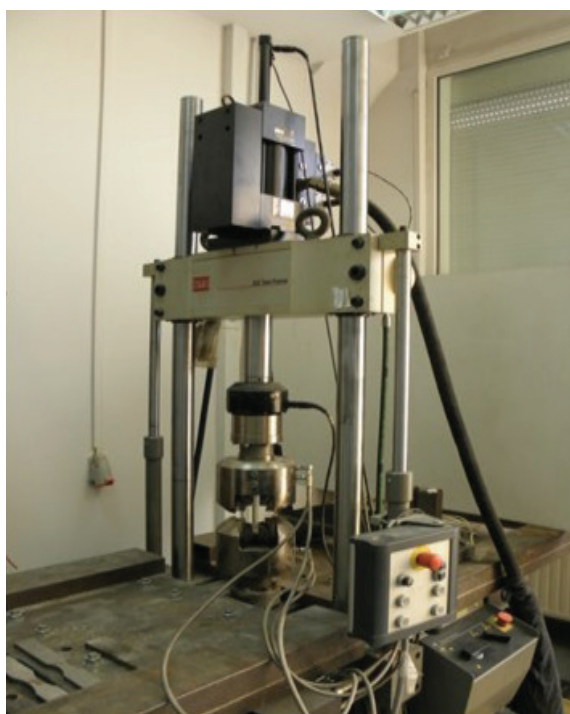
Dynamiczna maszyna wytrzymałościowa MTS 310 \pm 100 kN
