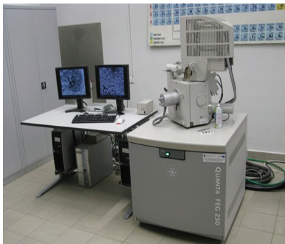
Mikroskop skaningowy SEM FEI QUANTA 250 FEG z mikrosondą EDS EDAX
